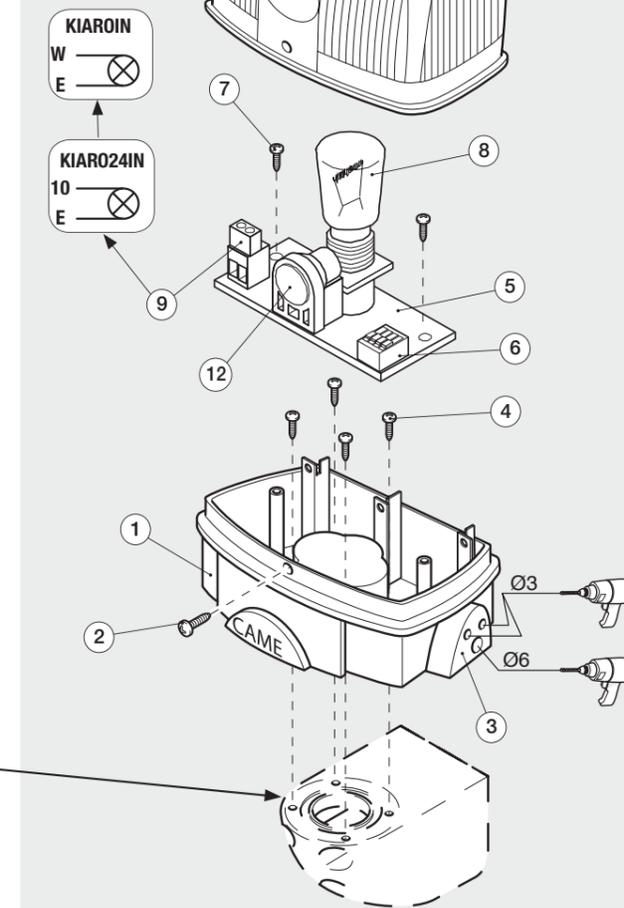
**FR** Clignotant de signalisation en ABS pour extérieur. Degré de protection IP 54 ; possibilité d'installation avec support KIAROS (en option) **A**.
